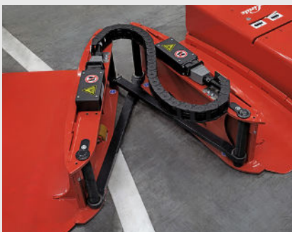
Einfache mechanische Konstruktion und wartungsfreie Energiekette
