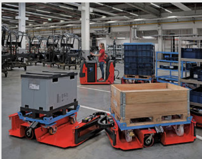
Minimaler Wenderadius mit sechs Rahmen dank Scheren-Zugstange
