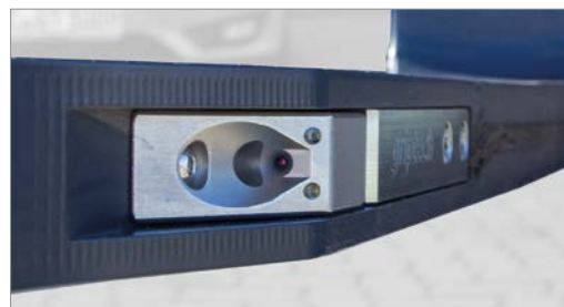
↑ Voll in die Kontur integrierte Kamera
