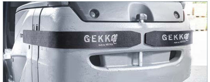
↑ Bei Nicht-Gebrauch haftet die Antirutschauflage einfach am Chassis des Staplers
