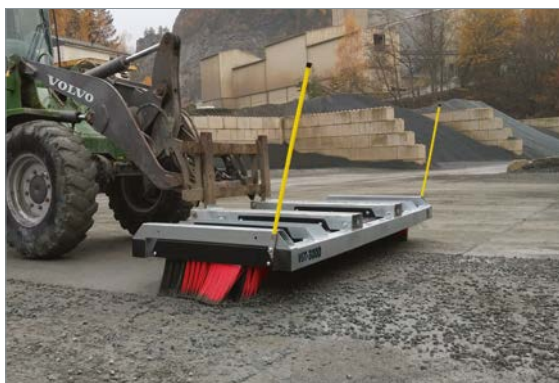
↑ Effiziente Grobreinigung: VST-3000 Kehrbesen im Baustelleneinsatz
