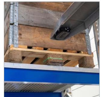
↑ Gabelzinken-Kamera zeigt exakt, was der Fahrer nicht sehen kann
