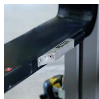
↑ Integrierte Gabelspitzenkamera – geschützt, präzise und perfekt im Blick
