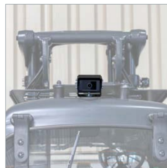
↑ Heckkamera für volle Rücksicht – robust, kompakt und wettergeschützt
