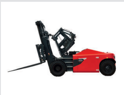
Servicezugang durch kippbare Kabine
