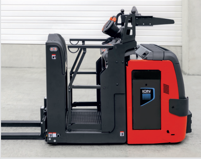
V08 ausgestattet mit einer Li-ION Batterie
