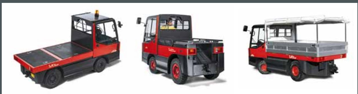
Pritsche W20, P250 mit Fenster-Ausschnitt für freie Sicht auf die Anhängerkupplung, W20 mit flexiblem Dach und klappbaren Bordwänden
