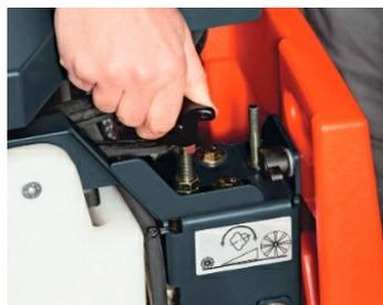
**Einfacher Verschleißausgleich:** Einstellung der Hauptkehrwalze mit ABBA-System (Automatische Behälter-Besen-Anpassung) für ein perfektes Kehrbild über die gesamte Lebensdauer der Walze.
