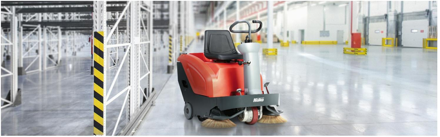
Leistung neu definiert: Der Sweepmaster B800 R vereint die kompakten Abmessungen einer Walk-behind-Kehrsaugmaschine mit dem hohen Komfort und der Leistungsfähigkeit einer Ride-on-Maschine. Kleine und mittlere Flächen lassen sich staubfrei und wirtschaftlich reinigen – mit einer Kehrleistung von bis zu 5.340 m<sup>2</sup>/h bzw. 6.600 m<sup>2</sup>/h.
