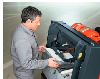
**Saubere Abluft und lange Einsatzzeiten:** Kassetten-Filterssystem mit großer Filterfläche und patentierter R<sup>2</sup>S-Filterreinigungstechnologie.
