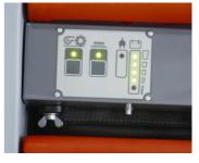
Übersichtlich: Die Kontrollanzeige vermittelt alle Funktionen der Kehrmaschine mit einfacher Symbolik.
