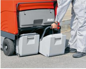
**Take-it-Easy:** Die beiden Behälter lassen sich einzeln herausnehmen und einfach entleeren. Die leicht bedienbare Behälteraushebung ermöglicht jederzeit eine Füllstandskontrolle oder das Einwerfen von sperrigen Kehrgehütern.
