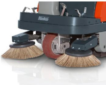
**Bis zu vier Seitenbesen:** Mit zusätzlichen Seitenbesen werden die Effizienz im Arbeitseinsatz und die Kehrleistung erhöht.
