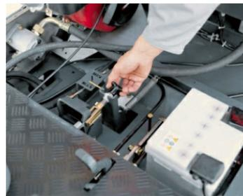
**Beseneinstellung:** Zentrale, werkzeuglose Verstellung des Kehrspiegels.
