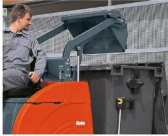
**Komfortable Hochentleerung:** Per Knopfdruck lässt sich der Kehrbehälter direkt in handelsübliche Container hochentleeren (Option).
