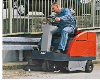
**Arbeitsicherheit:** Auch bei großer Steigung auf Rampen jederzeit sicher fahren und halten. Steigfähigkeiten je nach Modell: bis zu 16 %.
