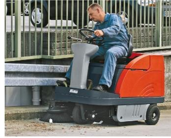
**Arbeitsicherheit:** Auch bei großer Steigung auf Rampen jederzeit sicher fahren und halten. Steigfähigkeit je nach Modell: bis zu 12 %.
