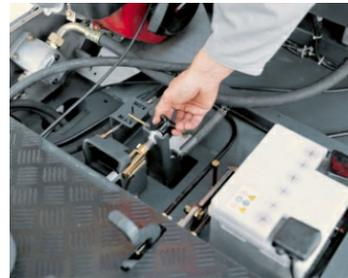
**Beseneinstellung:** Zentrale, werkzeuglose Verstellung des Kehrspiegels.
