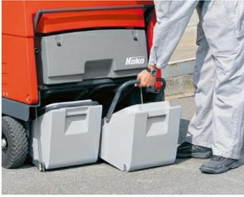
**Take-it-Easy:** Die beiden Behälter lassen sich einzeln herausnehmen und einfach entleeren. Die leicht bedienbare Behälteraushebung ermöglicht jederzeit eine Füllstandskontrolle oder das Einwerfen von sperrigen Kehrgrütern.
