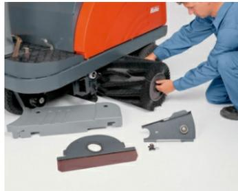
**Einfacher Walzenwechsel:** Die Kehrwalze lässt sich werkzeuglos und schnell austauschen.
