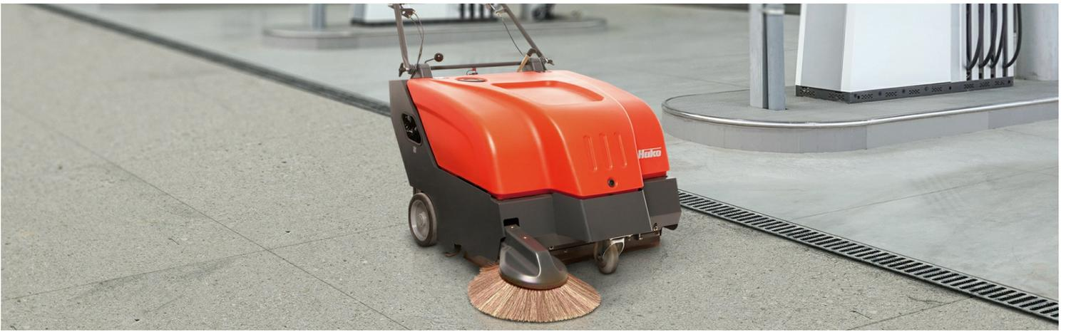
Optimiert für kleine und mittlere Flächen: Erzielen Sie gründliche Reinigungsergebnisse mit dem Sweepmaster 800. Die Kehrleistung beträgt bis zu 4.350 m<sup>2</sup>/h. Die Maschine arbeitet mit dem cleveren Überkopfwerferprinzip, das für eine maximale Behälterfüllung sorgt. So sind unterbrechungsfreies Arbeiten und erstklassige Kehrleistungen möglich. Die robuste Stahlrahmenbauweise in Heavy-Duty-Qualität macht den Sweepmaster zu einem Profigerät – für einwandfreie Sauberkeit auf lange Sicht.
