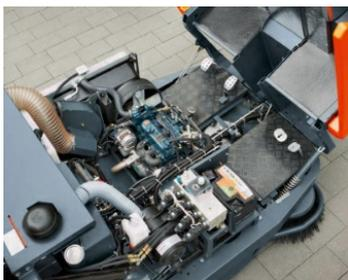
**Einfache Wartung:** Die Bedienerplattform kann für Servicearbeiten schnell und einfach auf- bzw. nach vorne geklappt werden.
