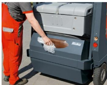
**Praktische Einwurfklappe** zur Aufnahme von größeren Gegenständen, Folien oder Bändern. Beim Einwurf kann kein Staub aus der Einwurfklappe austreten.
