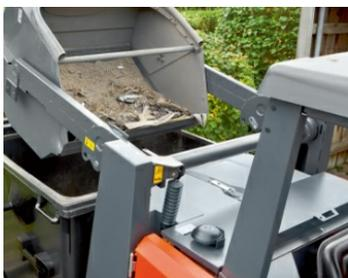
**Hydraulische Behälteraushebung:** Der Kehrgutbehälter kann bis 1,52 m hochentleert werden.
