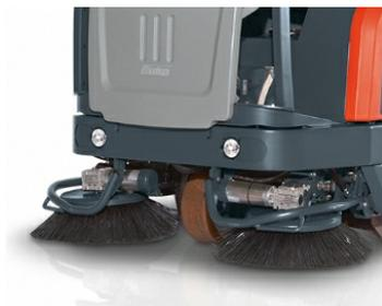
**Robustes Chassis und Anfahrerschutz:** Stabile Basis und Schutz der Besen vor Beschädigung für höchste Maschinenverfügbarkeit.
