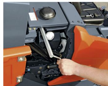
**Einfacher Verschleißausgleich:** Einstellung der Hauptkehrwalze mit ABBA- System (Automatische Behälter-Besen-Anpassung) für ein perfektes Kehrbild über die gesamte Lebensdauer der Walze.
