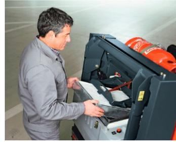
**Saubere Abluft und lange Einsatzzeiten:** Kassetten- Filtersystem mit großer Filterfläche und patentierter R<sup>2</sup>S- Filterreinigungstechnologie.
