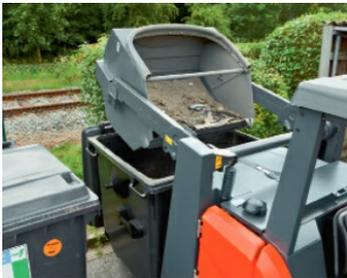
**Hydraulische Behälteraushebung:** Der 100 % nutzbare Kehrgutbehälter kann bis 1,42 m hochentleert werden.
