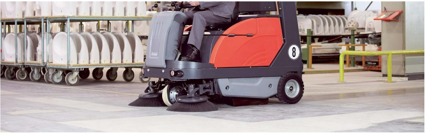
Leistung und Wirtschaftlichkeit für die Betriebsreinigung: der Sweepmaster 1200 RH. Mit erstklassiger Technik „made in Germany“ sind mit der Ride-on-Kehrsaugmaschine bis zu 13.200 m<sup>2</sup>/h Flächenleistung möglich. Sie ist ideal geeignet für das schnelle und besonders effiziente Kehrsaugen von Leer- und Produktionshallen sowie von befestigten Außenanlagen. Dank ihrer großen Steigfähigkeit hat sie auch jederzeit genug Kraftreserven für die Reinigung von Parkhäusern und Rampen.
