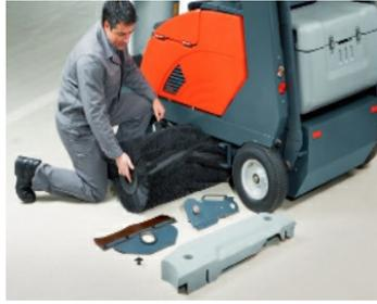
**Vorteilhafte Kehrwalzen:** Werkzeugloser Walzenwechsel und Wickelschutz gegen Lagerschäden beim Aufkehren von Folien und Bändern.
