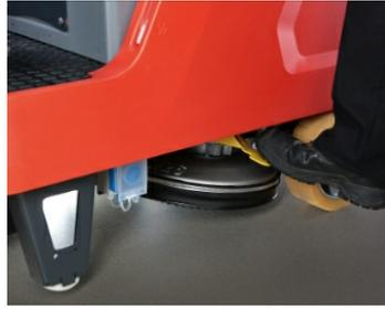
**Einfacher Bürstenabwurf:** Bequem und schnell mit nur einer Aktion (TB550: elektrisch; TB650: mechanisch).
