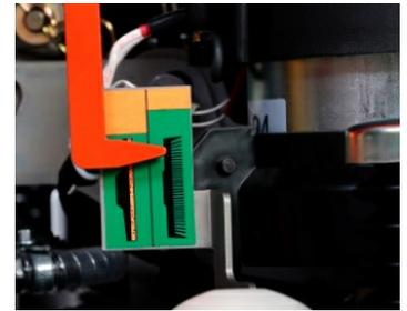
**Für permanent gute Reinigungsleistung:** Die mechanische Anzeige für Bürsten- und Padverschleiß zeigt an, wann die Bürste bzw. das Pad ersetzt werden muss.
