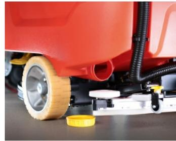
**Leicht zugängliche Revisionsöffnung:** Direkter Zugang zum Frischwassertank zum einfachen Reinigen bzw. Durchspülen.
