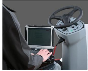
**Schnelle und einfache Diagnose:** Durch den guten Zugang zur Diagnose-Schnittstelle lassen sich Wartungen bzw. Änderungen von Fahreinstellungen direkt durchführen.
