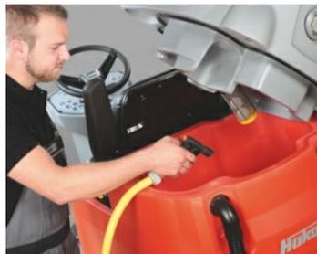
**Einfache Tankreinigung, keine Ablagerung von Schmutzresten**, denn alle Flächen im Tank sind glatt. Klar gekennzeichnet: Alle Komponenten, die geprüft und gewartet werden müssen, sind gelb.
