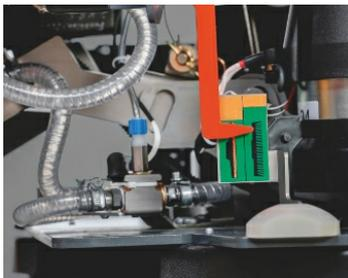
**Verschleißanzeige für Bürsten und Pads im Blick** und durch den komfortablen Abwurfmechanismus lassen sich die Bürsten ganz ohne Werkzeug schnell und einfach wechseln.
