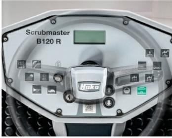
**Beleuchtetes, intuitiv bedienbares Display:** Mit 1-Knopf-Bedienung, Boost-Taste für maximale Wasserstufe und vollen Bürstendruck sowie Slow-Modus auf Knopfdruck.
