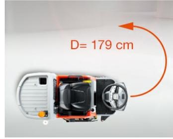
**Auch in engen Gängen und Fluren einsetzbar** dank besonders kompakter Bauweise. Lenkradeinschlag von 90 Grad, Wendekreis von nur 179 cm.
