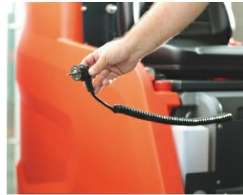
**Unkompliziertes Aufladen** an jeder herkömmlichen Steckdose – dank On-Board-Ladegerät.
