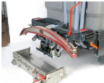
**Auf die Schnelle:** Der Saugfuß lässt sich sehr leicht nach oben klappen. Das ermöglicht eine schnelle Sichtkontrolle bzw. einen einfachen Dichtleistenwechsel.
