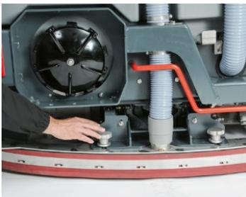
**Einfache Entsorgung:** Der Kehrgutbehälter ist durch das Anheben des Saugfußes leicht zu entnehmen. Dank der Leichtlaufrollen lässt er sich mühelos bewegen. Anschließend kann das Kehrgut einfach und sicher über die beiden Behälterereinsätze entsorgt werden.
