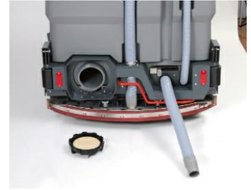
**Alles sauber:** Das Schmutzwasser kann durch den großen Ablassschlauch schnell ablaufen. Zwei große Deckel auf dem Tank und die 20 cm große Revisionsöffnung ermöglichen den einfachen Zugang zum Schmutzwassertank.
