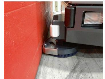
**Bis an den Rand:** Mit dem optionalen Seitenschrubbaggregat kommt die Maschine ganz an die Wände heran.
