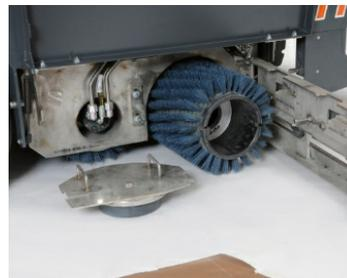
**Einfacher Bürstenwechsel:** Dank Schnellwechselsystem lassen sich die Walzenbürsten einfach austauschen – werkzeuglos.
