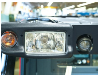
Arbeitsscheinwerfer im neuen, höhenverstellbaren Leuchenträger.
