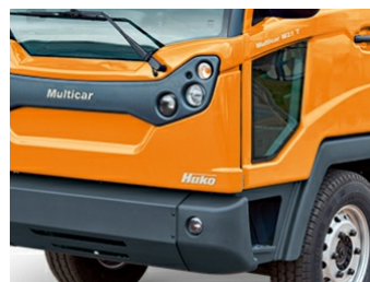
Nebelscheinwerfer vorn (LED)
