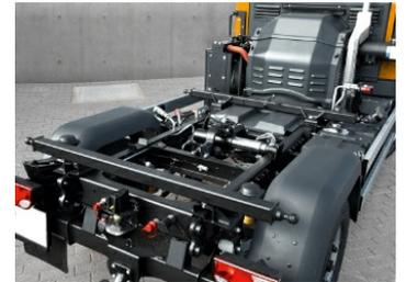
**Robustes Chassis mit Aufnahmepunkten** für wechselbare Aufbauten: vom Kipper für den Transport über Streugeräte und Solesprüher bis zu Wassertanks mit Pumpen.
