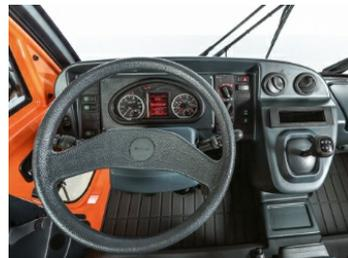
**Übersichtliches Cockpit mit Multifunktionsdisplay:** Die Info-Zentrale für den Fahrzeugführer mit Geschwindigkeits- und Drehzahlanzeige, Tankuhr, Wassertemperatur und digitalen Anzeigen für betriebsrelevante Informationen wie Hydrauliköltemperatur, Betriebsstunden, Hydraulik und Uhrzeit.
