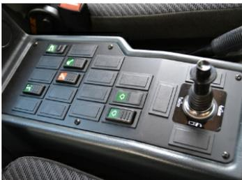
**Alles in Griffweite und im Griff:** Übersichtliches Bedienfeld mit allen Steuerungsfunktionen, Joystick für die zentrale Steuerung der Gerätefunktionen auch im Fahrbetrieb.
