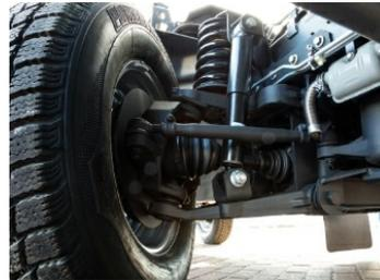
**Präzise Steuerung, hohe Fahrstabilität** durch komfortabel gefederte Einzelradaufhängung – ideal auch bei höheren Geschwindigkeiten und beim Einsatz von Vorbaugeräten.
