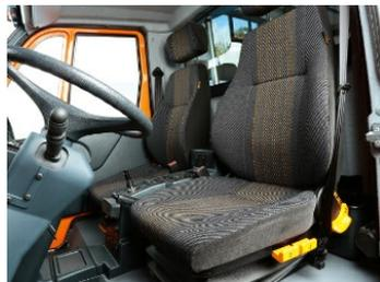
**Sicheres und ermüdungsfreies Arbeiten:** Ergonomisch geformte, individuell einstellbare Sitze mit Kopfstützen. Trittsicherer und bequemer Einstieg ins Cockpit mit zusätzlichen Haltegriffen.
