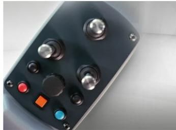
**Alle Funktionen im Griff:** Der Fahrer steuert alle Funktionen des Citymaster 2200 komfortabel über Joystick und Multifunktionsschalter.
