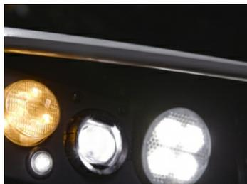
**Hell:** Die wartungsarme Voll-LED-Beleuchtung mit hoher Lichtausbeute und vergleichsweise geringem Leistungsbedarf sowie individuell zusammenstellbare LED-Arbeitsscheinwerfer für Besen, Saugmund und hintere Kabine.
