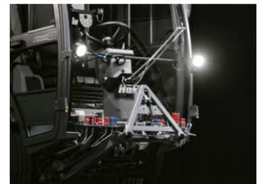
**Flexibel:** Vier Schnittstellen mit Schnellwechselsystem. Schnellkuppeldreieck vorn für einfachen Gerätewechsel, Schnittstelle an der Saugeinrichtung, Wechselrahmen für Heckaufbauten und hinterer Anbauahmen für weitere Zubehörteile und Anhängerzugvorrichtung.
