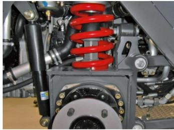
**Komfortabel:** Das Chassis ist vollgefedert. Der Fahrersitz ist luftgefedert und auf das Fahrwerk abgestimmt. Alles zusammen sorgt für den optimalen Federungskomfort für lange Einsatztage und schont auch das Fahrzeug.
