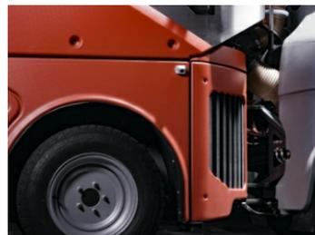
**Stabil:** Das mit großem Abstand ausgelenkte Knickgelenk mit wartungsfreien Lagern stellt eine stabile Verbindung zwischen Vorder- und Hinterwagen dar. Schraubenfedern, Stoßdämpfer und Stabilisatoren sorgen für sicheres Fahrverhalten auch bei hoher Zuladung und sicheres Befahren von Bordsteinkanten.
