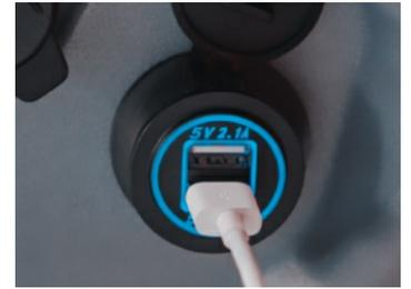
**Energiegeladen:** Dank USB-Anschluss an der Lenksäule kann der Fahrer während des Einsatzes sein Handy laden und ist auch im Notfall jederzeit erreichbar.
