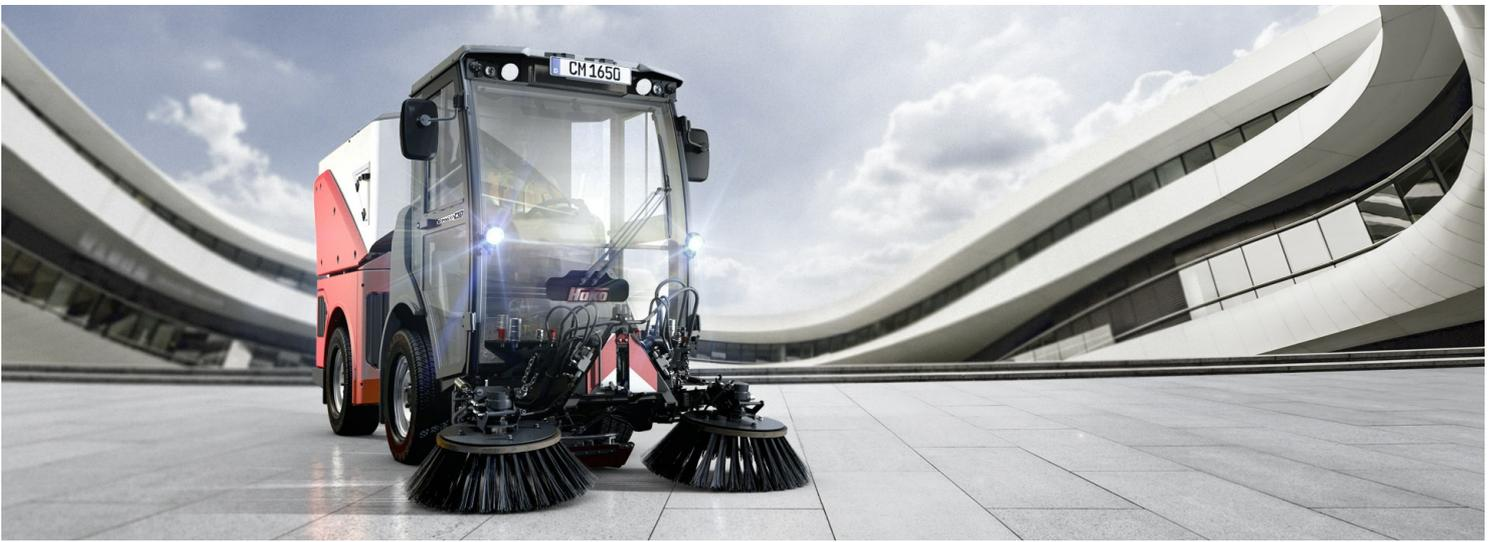
Die professionelle Kompakt-Reinigungsmaschine mit Zusatznutzen setzt neue Maßstäbe in der 3,5-t-Klasse: zum Beispiel mit Knicklenkung und permanentem Allradantrieb, hydraulischen Geräteantrieben und vollgefedertem Fahrwerk. Und bietet umfangreiche Neuerungen für mehr Arbeitskomfort, Sicherheit und Effizienz – egal ob in ausschließlicher Nutzung als Kompaktkehrmaschine oder als vielseitiger Geräteträger für den kommunalen Ganzjahreseinsatz.
