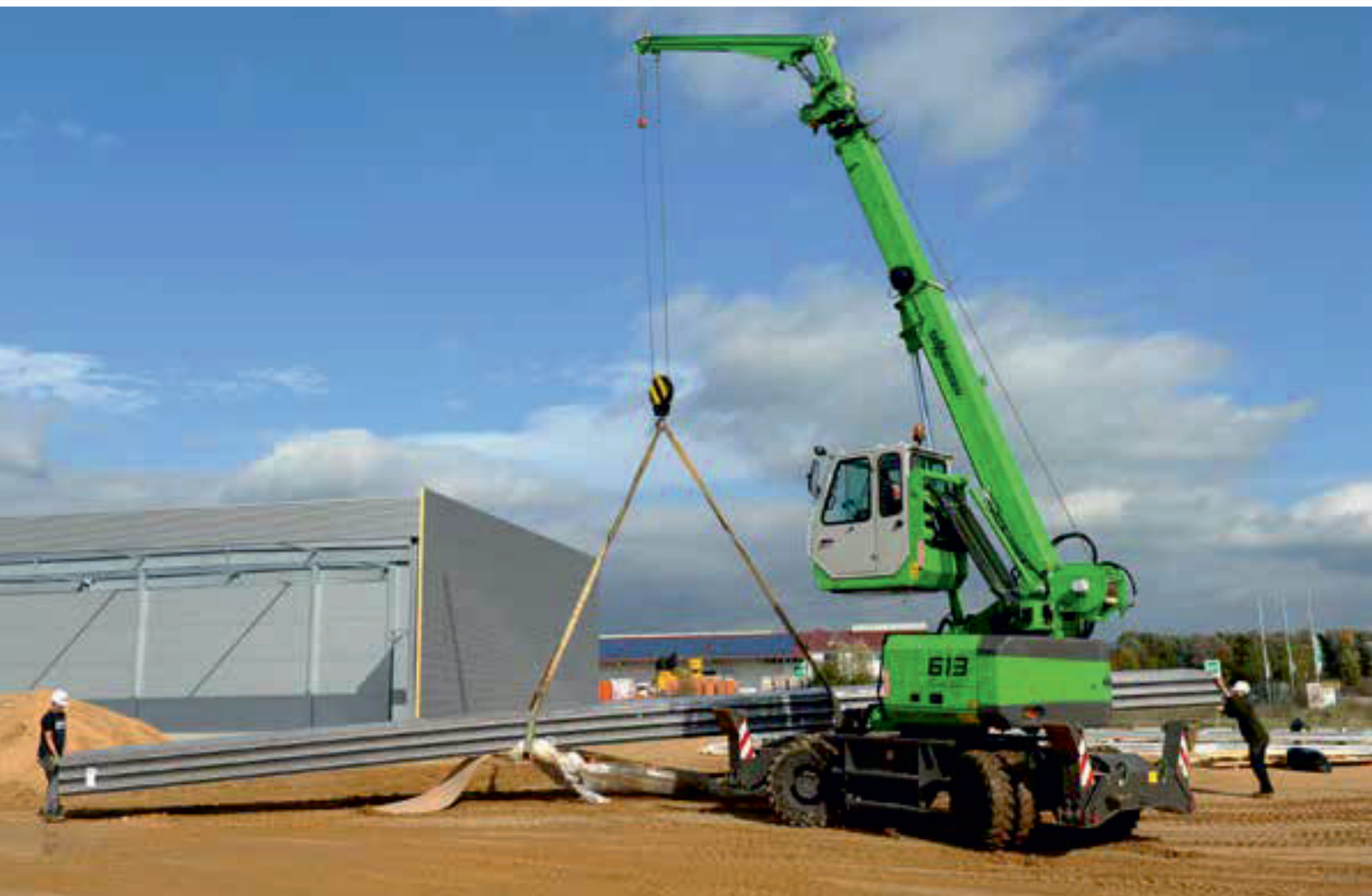
613 M – lift and move loads with folding fly jib, pick & carry; Germany 613 M – mit Klappspitze Lasten heben und verfahren, Pick & Carry; Deutschland
